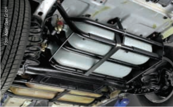
Unterflurig eingebaute Erdgastanks.
